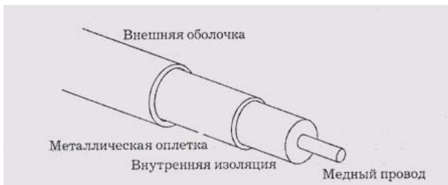
Рис. 2.2. Коаксиальный кабель
